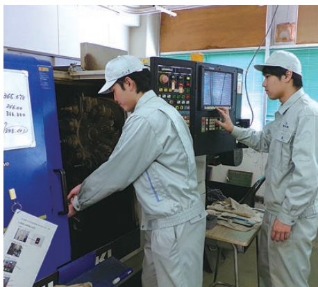
NC旋盤でのコマ作り
